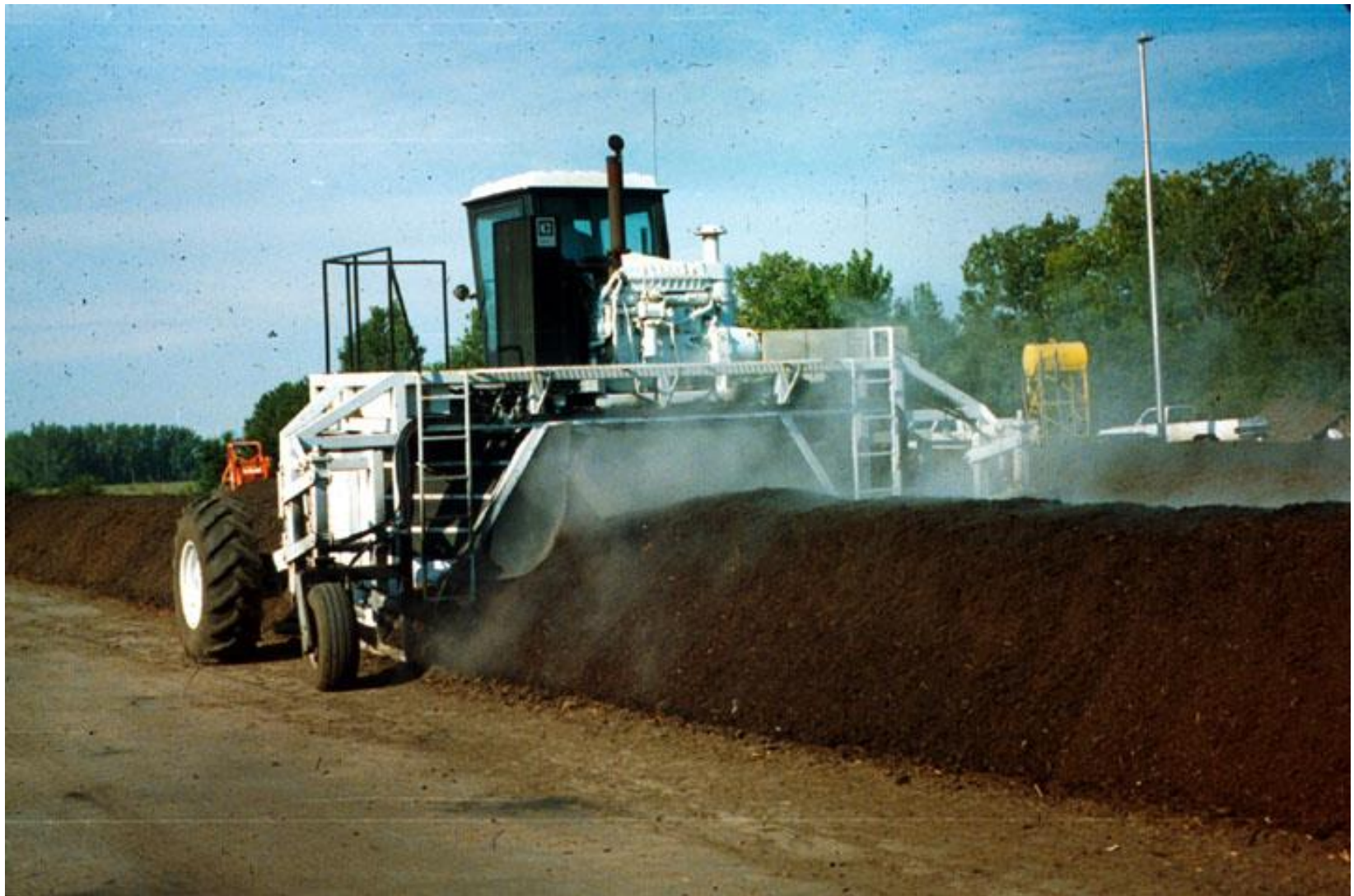
شمایی از روش WINDROW
