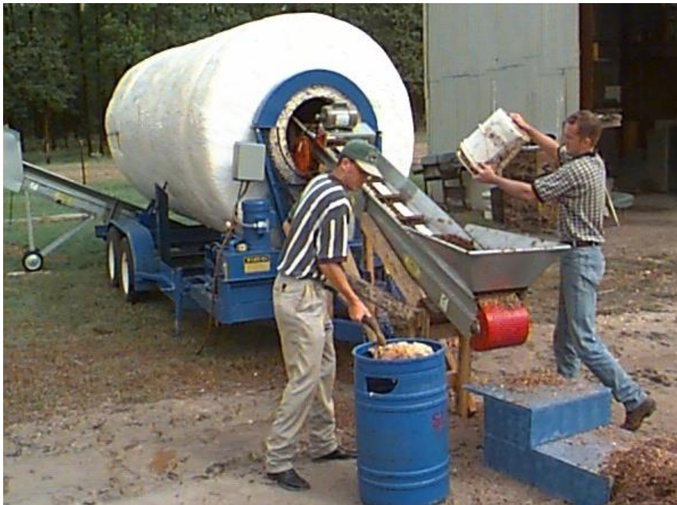
نمونه ای از یک سیستم تولید کمپوست به روش درام
