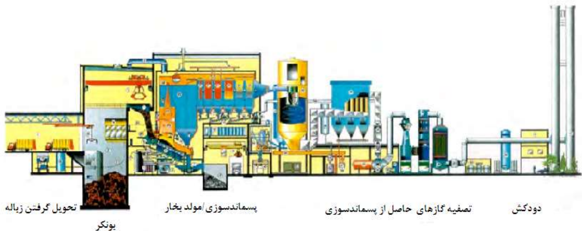
شکل ح-۱- مثالی از نقشه یک تأسیسات پسماندسوز پسماندهای شهری
